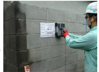
コンクリートブロック内の鉄筋探査状況
