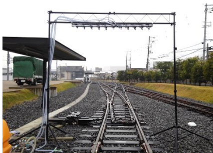
鉄道会社実験用の 豪雨再現装置
