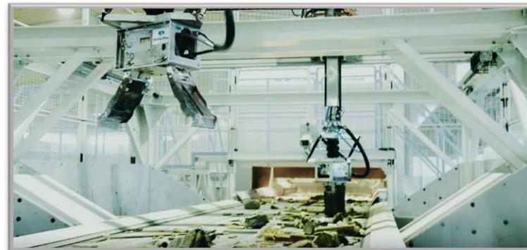
2016年にサンライズFUKAYA工場にフィンランド製のAIロボットが導入されており、混合廃棄物の選別が自動で行われています。
